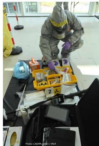
A radiológiai bűnügyi helyszíneléshez használt eszközök és speciális védőruházat
