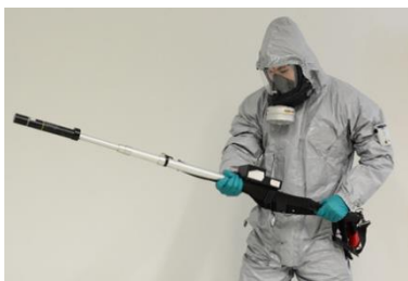
A helyszín dózisviszonyainak megismerése teleszkópos dózisteljesítmény-mérővel
