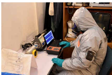
Helyszíni gamma-spektrometriai mérés.
